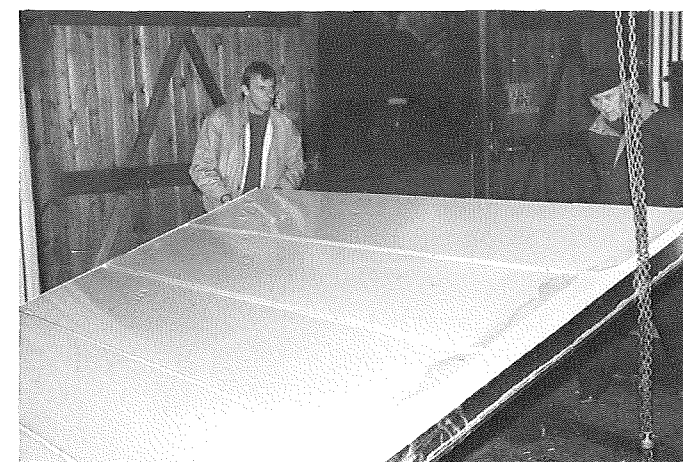
Figur 39. De færdiglakerede beklædningskassetter forsynet med en plastfilm til beskyttelse mod ridser og snavs.
